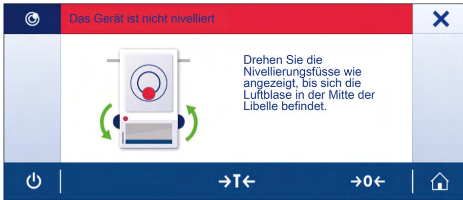
Nach Befolgung der Anweisungen zeigt der Nivellierungsassistent die nächsten Schritte. Befolgen Sie alle Schritte, bis die Waage nivelliert ist.
